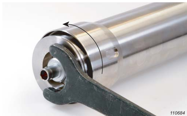
Abb. D.5 Basis von Typ 4184-A und Stiftschlüssel: Entgegen dem Uhrzeigersinn abschrauben
