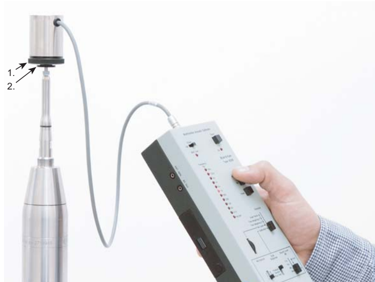
Abb. D.4 Wetterfeste Mikrofoneinheit Typ 4184-A und Kalibrator Typ 4226 mit 1. Akustischer Kuppler UA-1231 und 2. Kalibrieradapter DB-4199
