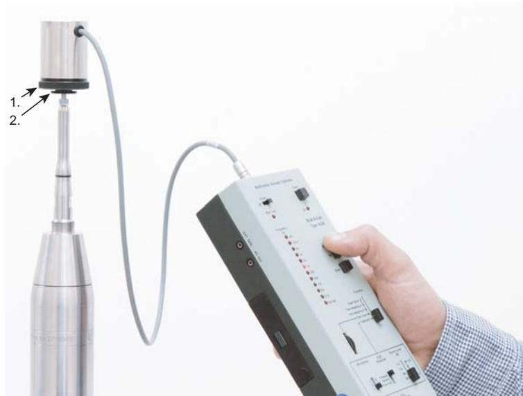
**Nota:** assemblando di nuovo il microfono, la punta estrema deve essere allineata con il resto del microfono. Se manca questo allineamento, occorrerà inviare il microfono ai laboratori Brüel & Kjær per riparazione.
