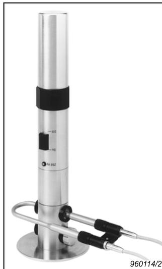
**Nota :** Ne pas placer le coupleur dans un endroit chaud, par exemple au sommet d'un instrument de mesure, car la chaleur influe sur le calibrage
