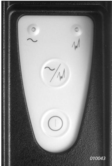
**Nota :** Si aucune sonde n'est positionnée dans l'appareil, celui-ci s'éteint après environ dix secondes
