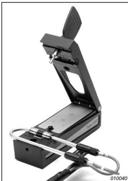
**Nota :** Pour l'obtention d'un meilleur résultat, il est conseillé de retirer le bloc d'espacement. Mais celui-ci doit aider (sans être vissé) à obtenir la bonne distance entre les deux microphones (voir Fig. 3.8.). Serrer le joint de compression pour maintenir cet écartement, puis retirer le bloc d'espacement avant de placer la sonde dans le calibreur
