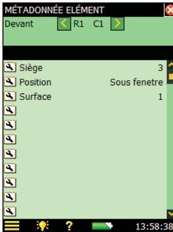
En haut de l’affichage (Fig. 4.7) apparaissent le sélecteur de surface et les flèches de sélection pour choisir d’afficher d’autres Surfaces et Eléments.
