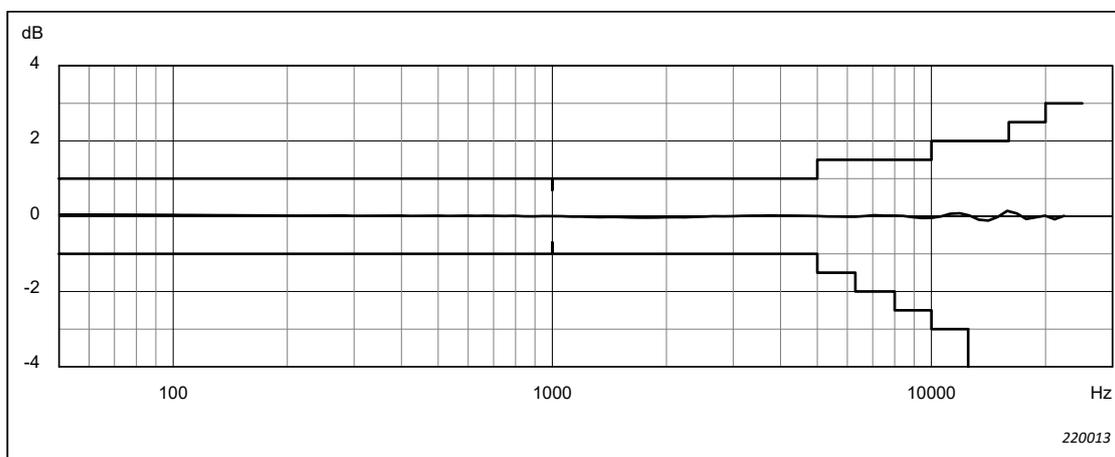
**Abb. 4.4** Einfluss des Gerätekörpers des Schallpegelmessers auf den 0°-Freifeld-Frequenzgang, entspricht der Spalte „Gerätekörper Einfluss“ in Tabelle A.3
