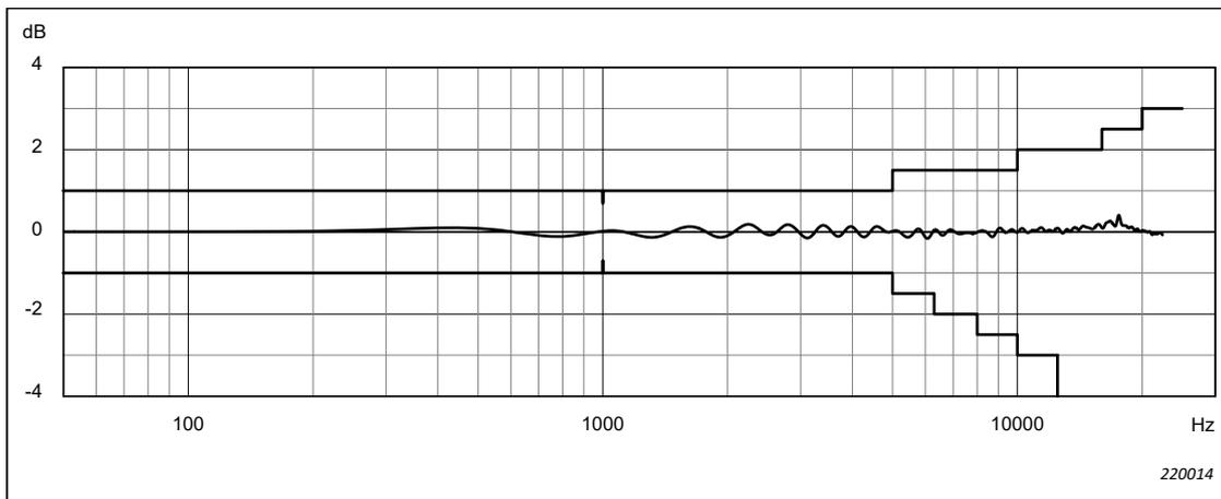
**Abb. 4.5** 0°-Freifeld-Frequenzgang für Mikrofon Typ 4966, Mikrofonvorverstärker ZC-0043 und den Schallpegelmessers, wenn der Mikrofonvorverstärker direkt am Schallpegelmessers angebracht ist. Entspricht der Spalte „Akustischer Frequenzgang“ in Tabelle A.3
