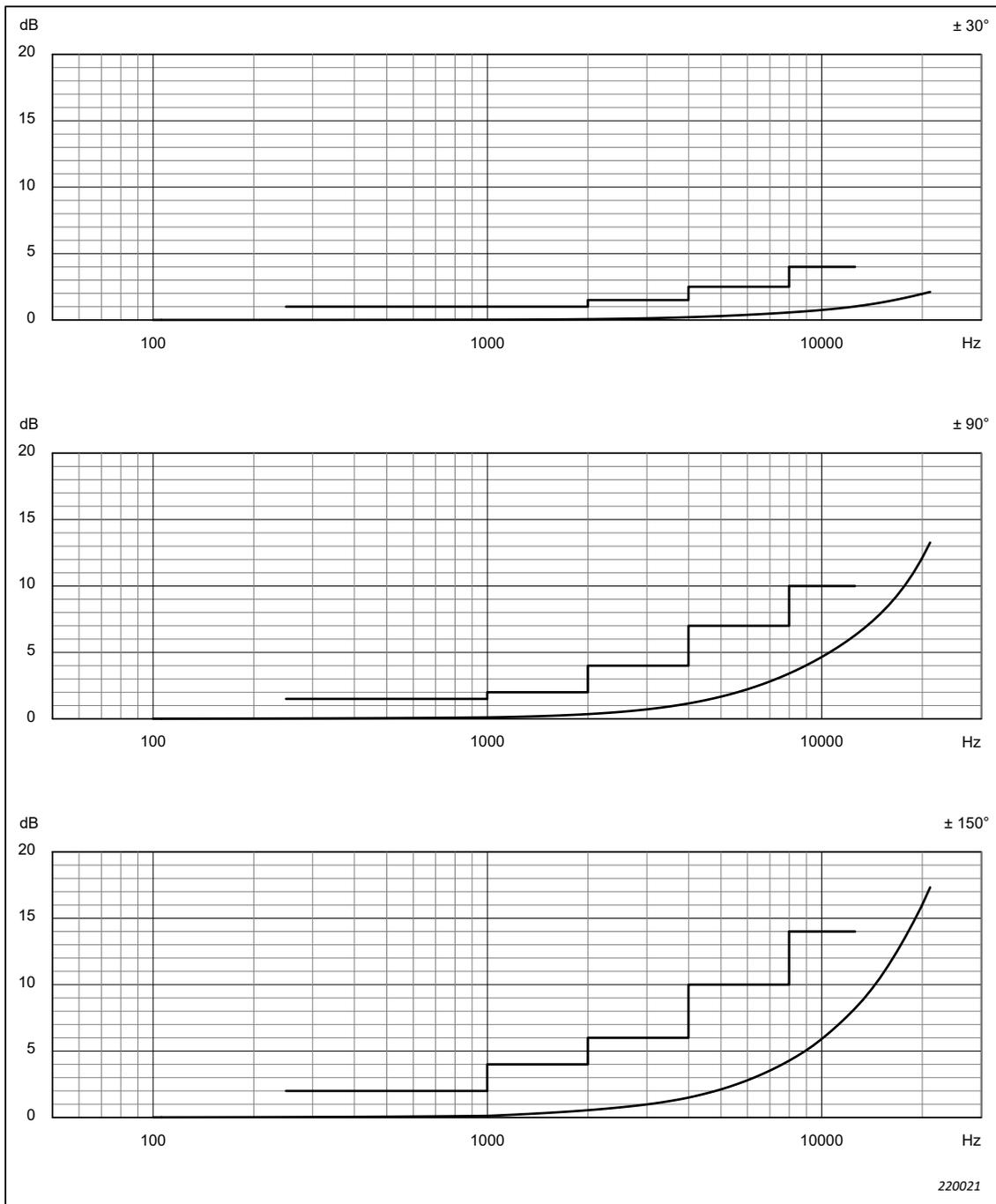
**Abb. 4.12** Richtcharakteristik für Mikrofon Typ 4966, Mikrofonvorverstärker ZC-0043 und den Schallpegelmesser, wenn der Mikrofonvorverstärker direkt am Schallpegelmesser angebracht ist, in einer zum Display parallelen Ebene und entlang der Mikrofonachse gemessen. Entspricht Tabelle A.13 bis Tabelle A.15
