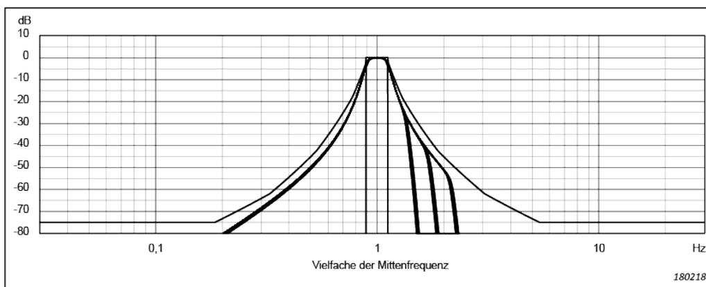
**Abb. 4.25** Form der Terzbandfilter (von 0 bis -3,5 dB). Die innere und äußere Kurve zeigen die Grenzen nach IEC 61260
