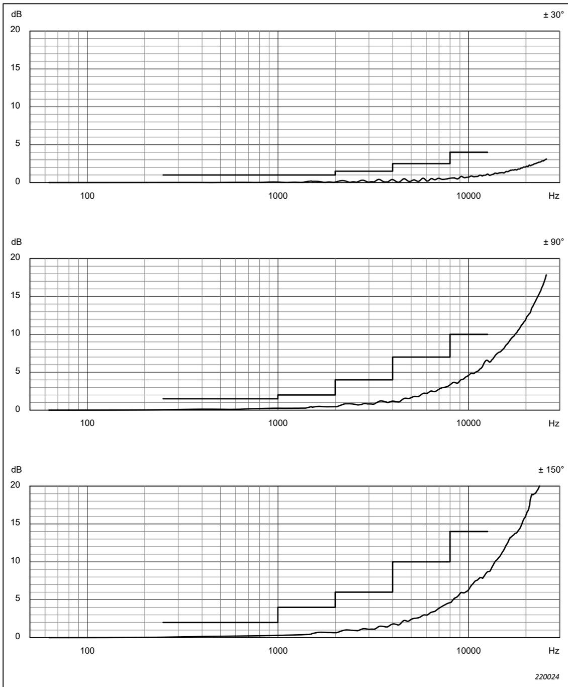
**Abb. 4.15** Richtcharakteristik für Windschirm UA-1650, Mikrofon Typ 4966 und Mikrofonvorverstärker ZC-0043, wenn der Mikrofonvorverstärker mit einem Mikrofonverlängerungskabel verbunden ist. Entspricht Tabelle A.20 bis Tabelle A.22
