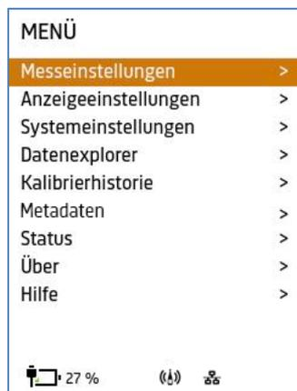
Navigieren Sie mit der Aufwärts-/Abwärtstaste ( $\Delta$  /  $\nabla$ ) des Schallpegelmessers durch das Menü. Um bestimmte Einstellungen zu sehen, verwenden Sie die Links-/Rechts-Taste ( $\langle$  /  $\rangle$ ).
