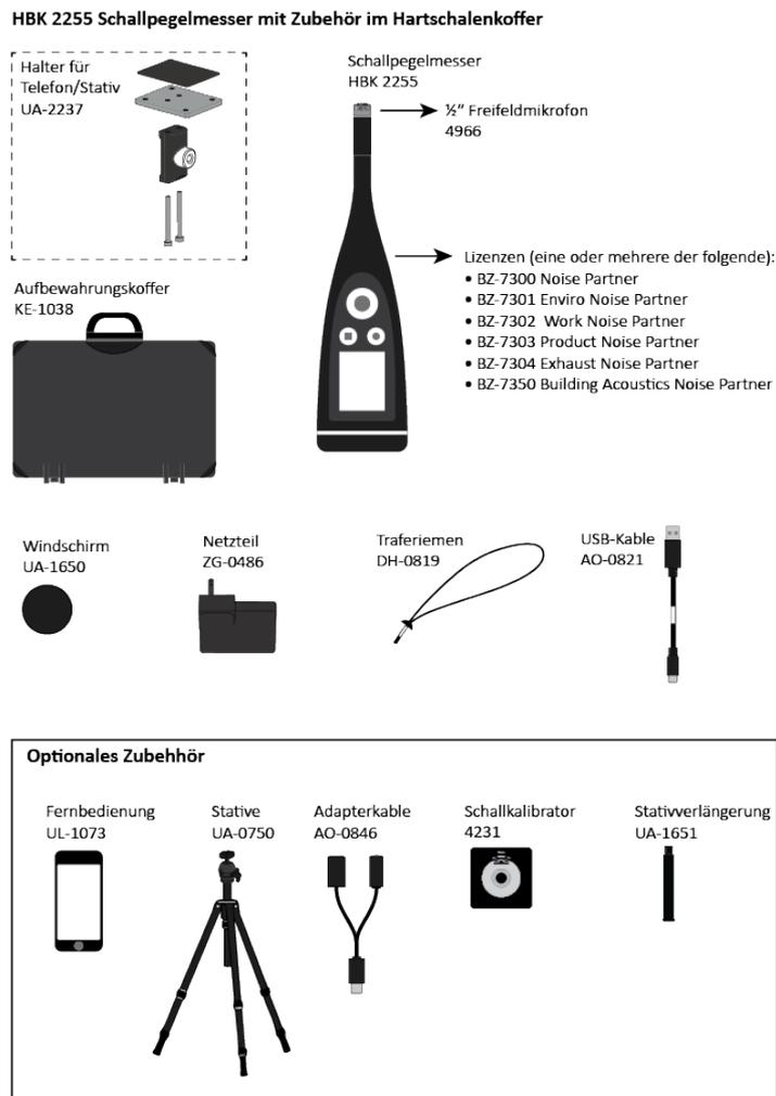
**Tabelle 1.1** Für die Konformitätsprüfung des Schallpegelmessers Typ 2255 benötigte Komponenten
