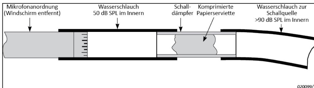
Um zu verhindern, dass die Schallquelle durch Störgeräusche aus der Umgebung beeinflusst wird, kann folgende Methode verwendet werden:
