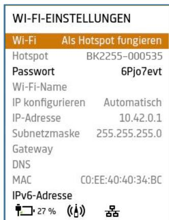
Gehen Sie zu **Systemeinstellungen > Netzwerkeinstellungen > Wi-Fi-Einstellungen**, um die Verbindung zu Wi-Fi herzustellen. Setzen Sie *Wi-Fi* auf:
