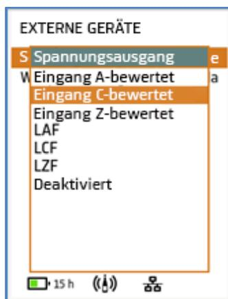
Gehen Sie zu **Systemeinstellungen > Externe Geräte**, um über den USB-C/3,5 mm-Miniklinken-Adapter AO-0846 an der USB-C-Buchse ein analoges Signal auszugeben.
