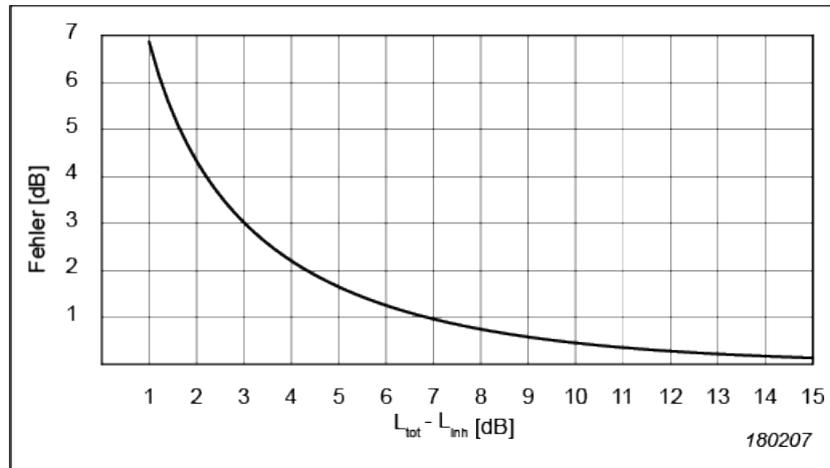
Abb. 2.1 zeigt den Fehler, mit dem die gemessenen Schalldruckpegel durch das Eigenrauschen behaftet sind. Die Kurve kann auch zur Kompensation verwendet werden, indem der Fehler von den Messwerten subtrahiert wird. Dies führt zu denselben Ergebnissen wie mit der Formel.
