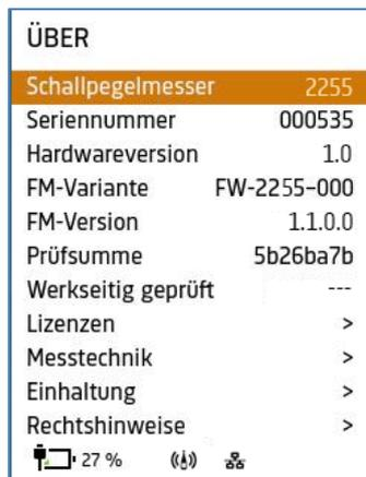
Gehen Sie zu **Über**, um die Seriennummer, Hardwareversion, Firmwarevariante und aktuell installierte Firmwareversion des Schallpegelmessers zu sehen.
