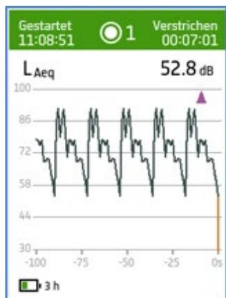
**Bitte beachten:** Verwenden Sie in den Messanzeigen ◀ / ▶, um den (Haupt-) Parameter in der Anzeige zu wechseln, ohne zu den *Anzeigeeinstellungen* zu gehen.
