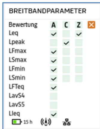
Navigieren Sie mit den Pfeiltasten am Schallpegelmesser zwischen den wählbaren Feldern und drücken Sie
