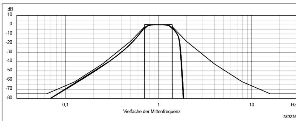
**Abb. 4.23** Form der Oktavbandfilter (von 0 bis -3,5 dB). Die innere und äußere Kurve zeigen die Grenzen nach IEC 61260
