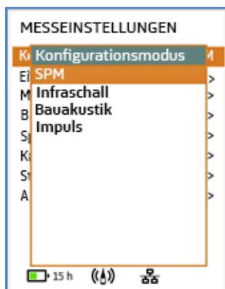
Für jeden Konfigurationsmodus enthält der Schallpegelmesser eine komplette Konfiguration – beim Wechsel zu einem anderen Modus wird die entsprechende Konfiguration geladen und das Programm neu initialisiert. Dies geschieht innerhalb von 20 s.
