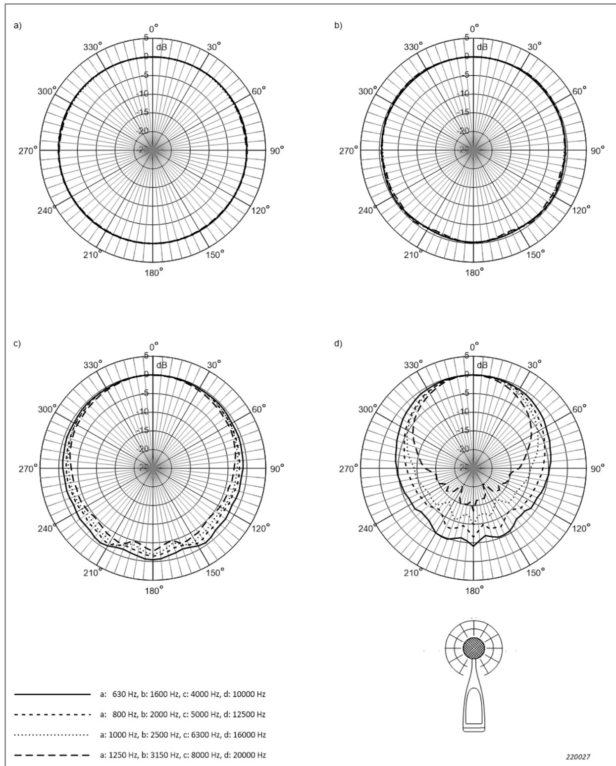
**Abb. 4.18** Richtcharakteristik für Windschirm UA-1650, Mikrofon Typ 4966, Mikrofonvorverstärker ZC-0043 und den Schallpegelmesser, wenn der Mikrofonvorverstärker direkt am Schallpegelmesser angebracht ist, in einer zum Display senkrechten Ebene und entlang der Mikrofonachse gemessen. Entspricht Tabelle A.27 bis Tabelle A.29
