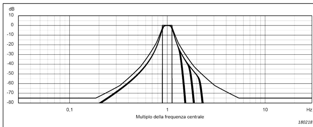
**Fig. 4.25** Le forme dei filtri in banda di 1/3 d'ottava (da 0 a -3,5 dB). Le curve più interne e quelle più esterne mostrano i limiti dati dalla IEC 61260
