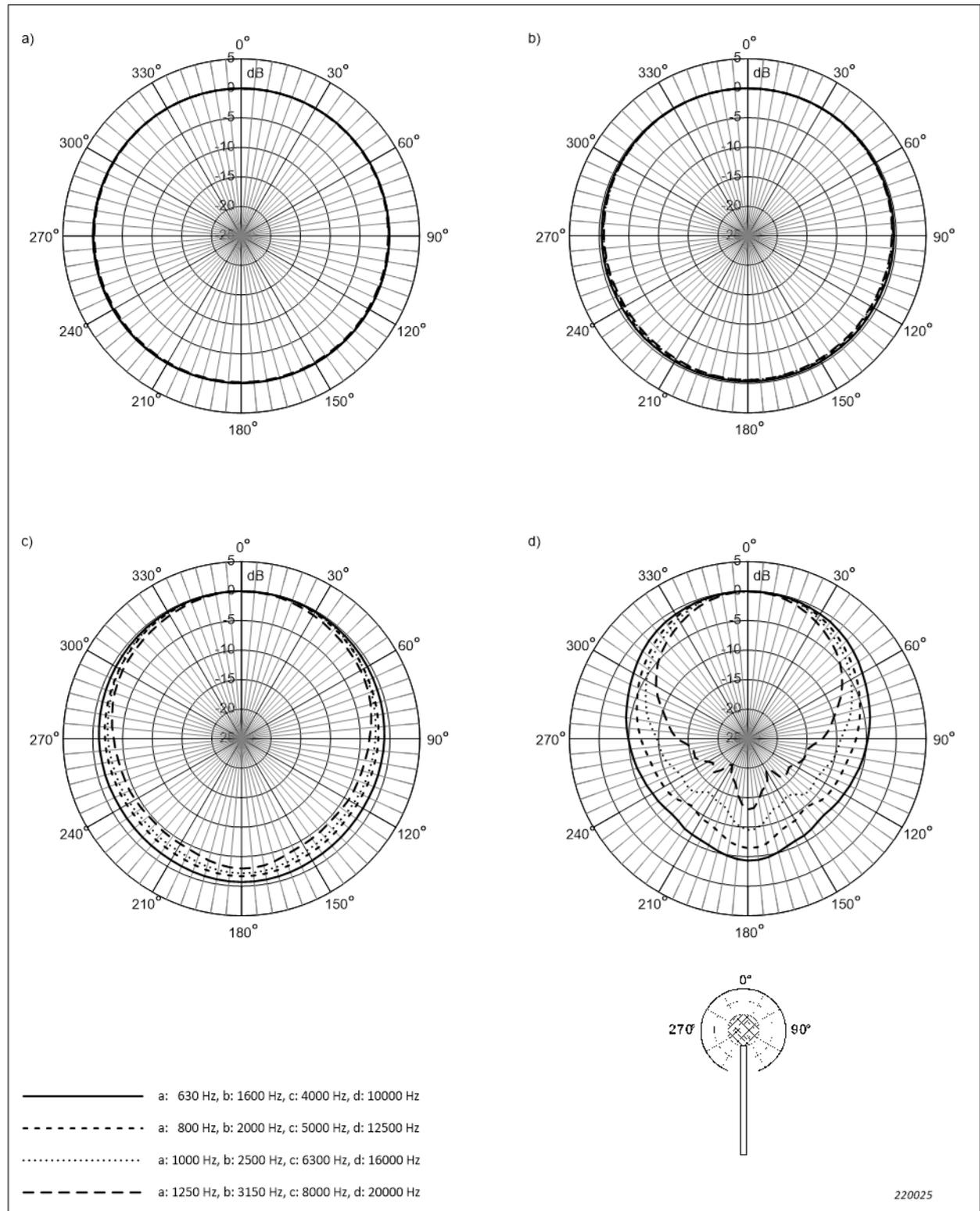
**Fig. 4.16** *Variazioni della sensibilità per Schermo antivento UA-1650, Microfono Tipo 4966 e Preamplificatore microfonico ZC-0043, con il preamplificatore microfonico collegato ad un cavo estensione microfono, agli angoli d'incidenza sonora compresi tra  $\pm \theta^\circ$  dalla direzione di riferimento. Corrisponde alla Tabella A.23*
