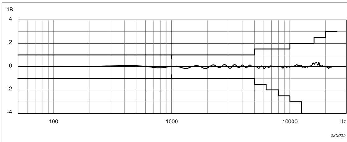
**Fig. 4.6** Risposta in frequenza in campo libero 0° per Schermo antivento UA-1650, Microfono Tipo 4966, Preamplificatore microfonico ZC-0043 e risposta elettrica del fonometro, con il preamplificatore microfonico collegato ad un cavo estensione microfono. Corrisponde alla colonna "Risposta acustica" della Tabella A.4
