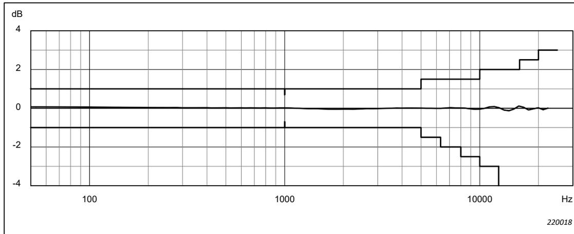
**Fig. 4.9** Risposta in frequenza in campo diffuso per Schermo antivento UA-1650, Microfono Tipo 4966, Preamplificatore microfonico ZC-0043 e fonometro, con o senza il preamplificatore microfonico collegato ad un cavo estensione microfono. Corrisponde alla colonna "Risposta acustica" della Tabella A.7
