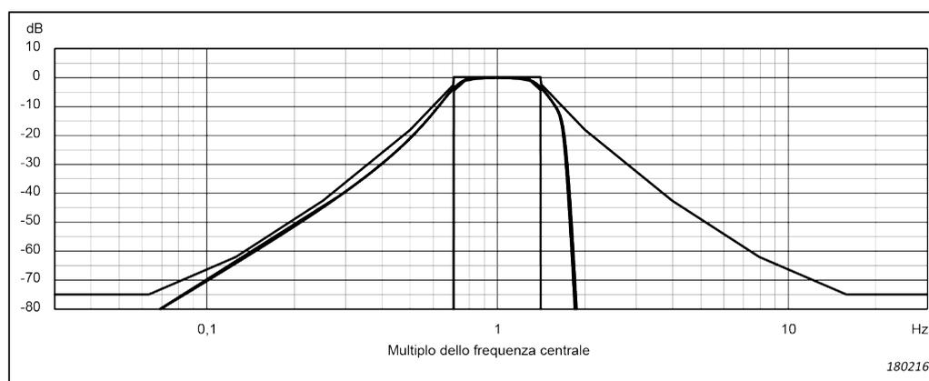
**Fig. 4.23** Le forme dei filtri in banda di 1/1 d'ottava (da 0 a -3,5 dB). Le curve più interne e quelle più esterne mostrano i limiti dati dalla IEC 61260
