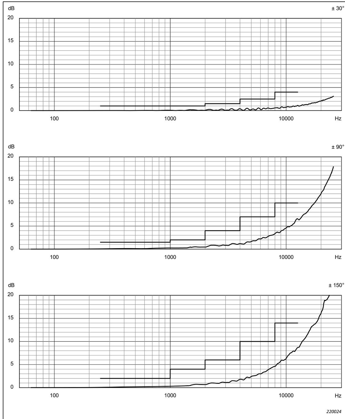
**Fig. 4.15** Risposta direzionale per Schermo antivento UA-1650, Microfono Tipo 4966 e Preamplificatore microfonico ZC-0043, con il preamplificatore microfonico collegato ad un cavo estensione microfono. Corrisponde dalla Tabella A.20 alla Tabella A.22
