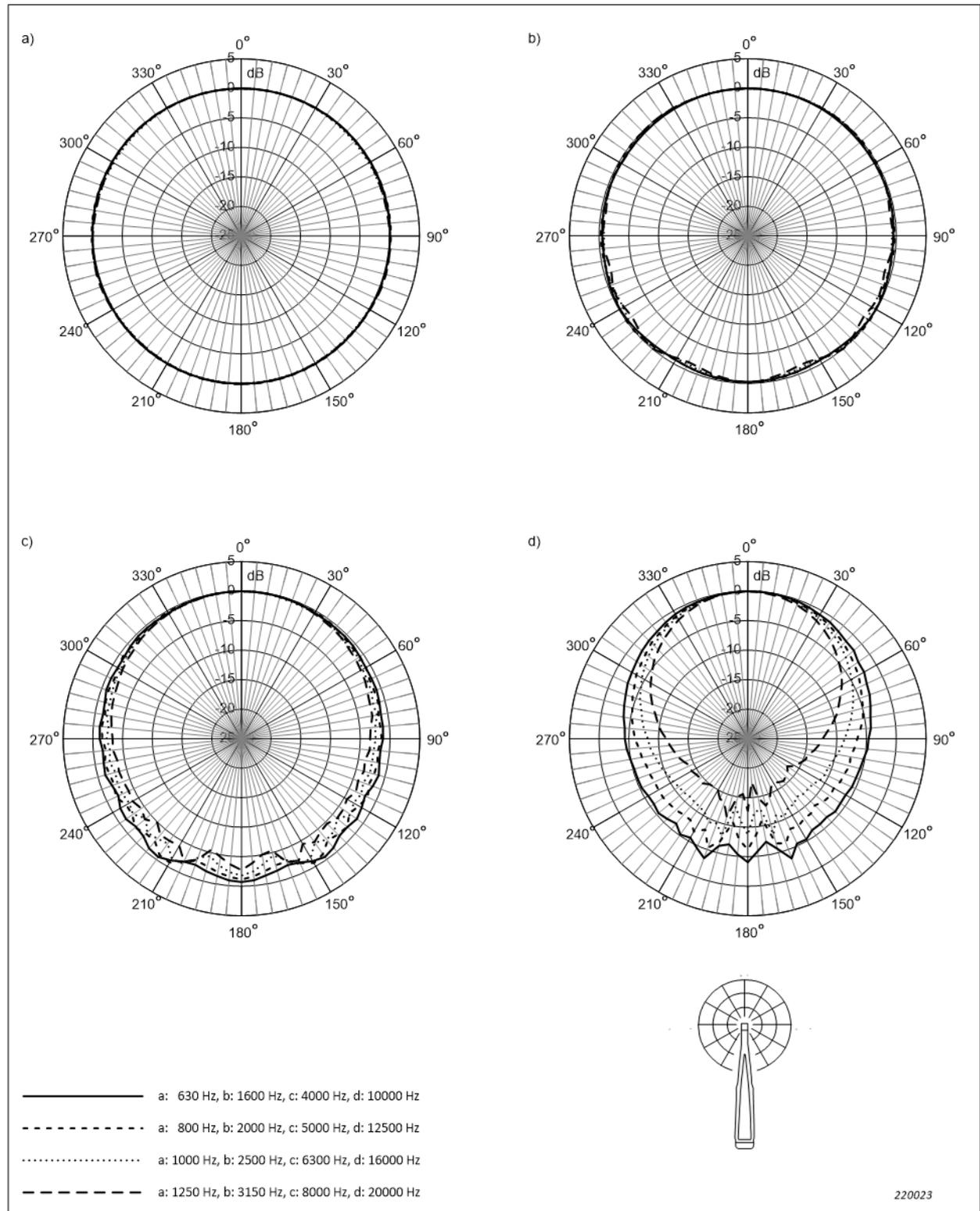
**Fig. 4.14** *Variazioni della sensibilità per Microfono Tipo 4966, Preamplificatore microfonico ZC-0043 e fonometro, con il preamplificatore microfonico montato direttamente sul fonometro, agli angoli d'incidenza sonora compresi tra  $\pm \theta^\circ$  dalla direzione di riferimento. Corrisponde alla Tabella A.19*
