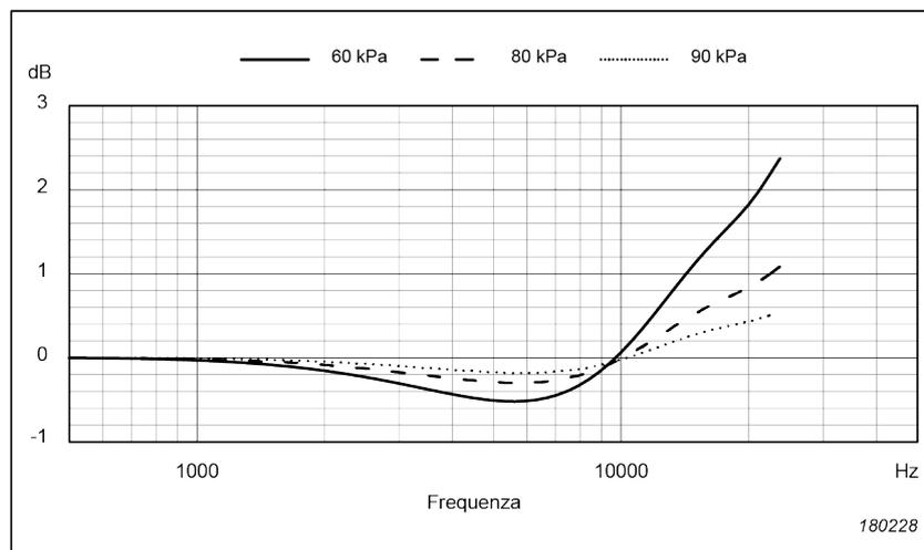
**Fig. 2.3** *Variazione tipica nella sensibilità a 250 Hz da quella a 101,3 kPa come funzione della pressione ambientale*
