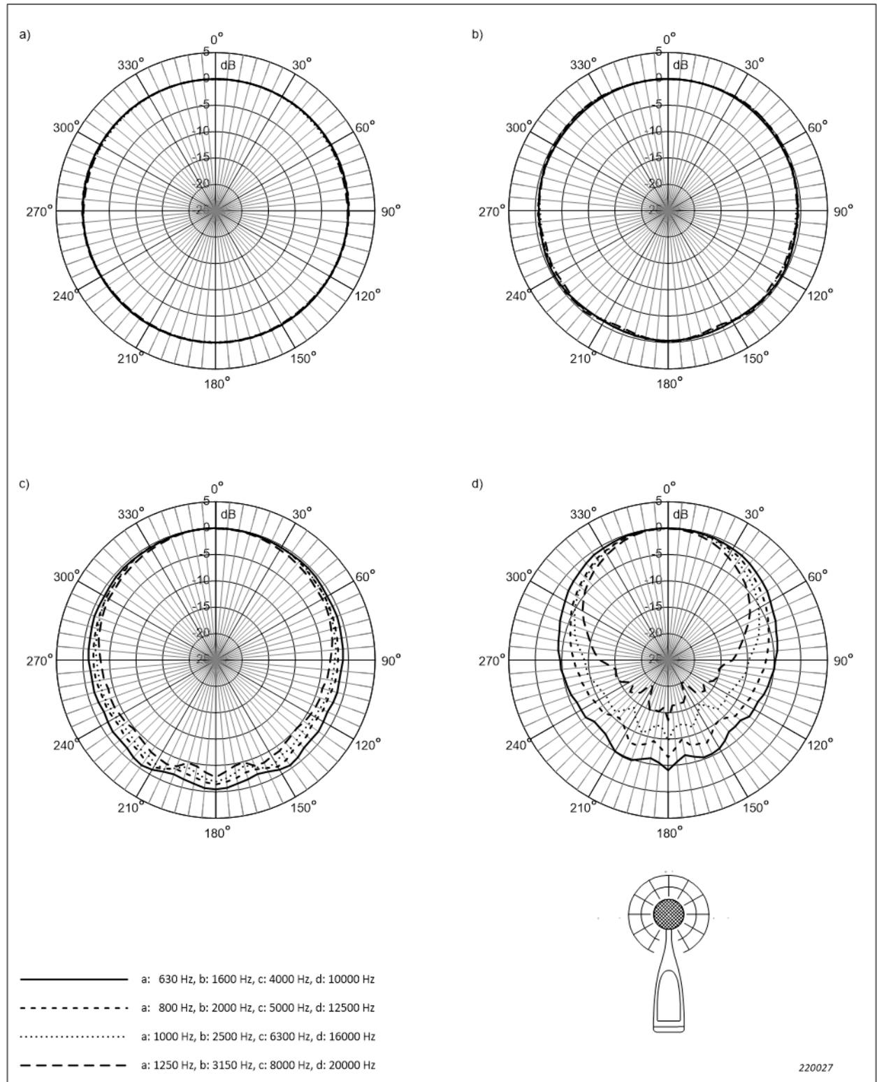
**Fig. 4.18** Risposta direzionale per Schermo antivento UA-1650, Microfono Tipo 4966, Preamplificatore microfonico ZC-0043 e fonometro, con il preamplificatore microfonico montato direttamente sul fonometro, misurata in un piano perpendicolare al display e lungo l'asse del microfono. Corrisponde dalla Tabella A.27 alla Tabella A.29
