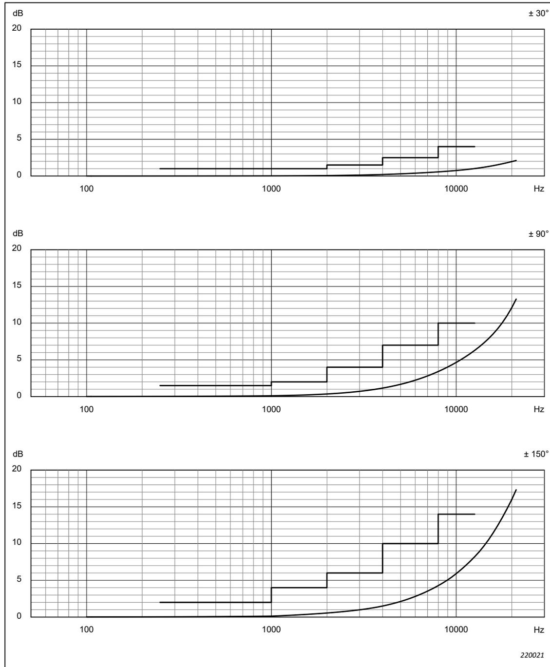
**Fig. 4.12** Risposta direzionale per Microfono Tipo 4966, Preamplificatore microfonico ZC-0043 e fonometro, con preamplificatore microfonico montato direttamente sul fonometro, misurata in un piano parallelo al display e lungo l'asse del microfono. Corrisponde dalla Tabella A.13 alla Tabella A.15
