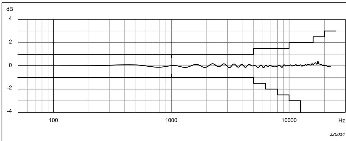
**Fig. 4.5** Risposta in frequenza in campo libero 0° per Microfono Tipo 4966, Preamplificatore microfonico ZC-0043 e fonometro, con il preamplificatore microfonico montato direttamente sul fonometro. Corrisponde alla colonna "Risposta acustica" della Tabella A.3
