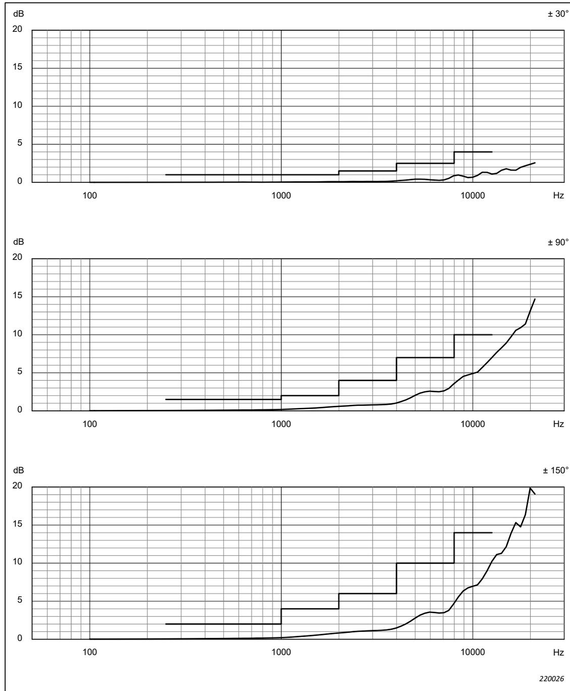
**Fig. 4.17** Risposta direzionale per Schermo antivento UA-1650, Microfono Tipo 4966, Preamplificatore microfonico ZC-0043 e fonometro, con il preamplificatore microfonico montato direttamente sul fonometro, misurata in un piano parallelo al display e lungo l'asse del microfono. Corrisponde dalla Tabella A.24 alla Tabella A.26
