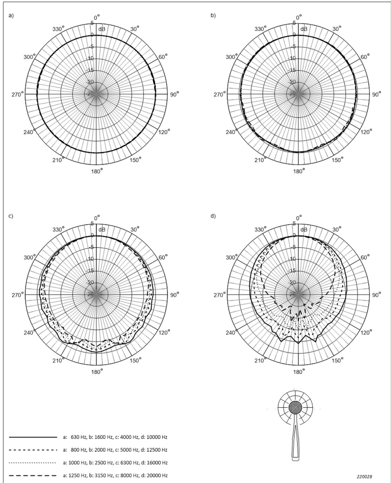
**Fig. 4.19** *Variazioni della sensibilità per Schermo antivento UA-1650, Microfono Tipo 4966, Preamplificatore microfonico ZC-0043 e fonometro, con il preamplificatore microfonico collegato direttamente sul fonometro, agli angoli d'incidenza sonora compresi tra  $\pm \theta^\circ$  dalla direzione di riferimento. Corrisponde alla Tabella A.30*
