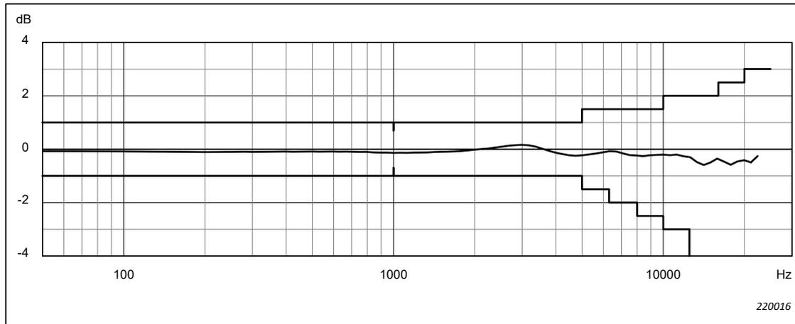
**Fig. 4.7** Risposta in frequenza in campo libero 0° per Schermo antivento UA-1650, Microfono Tipo 4966, Preamplificatore microfonico ZC-0043 e fonometro, con il preamplificatore microfonico montato direttamente sul fonometro. Corrisponde alla colonna "Risposta acustica" della Tabella A.5
