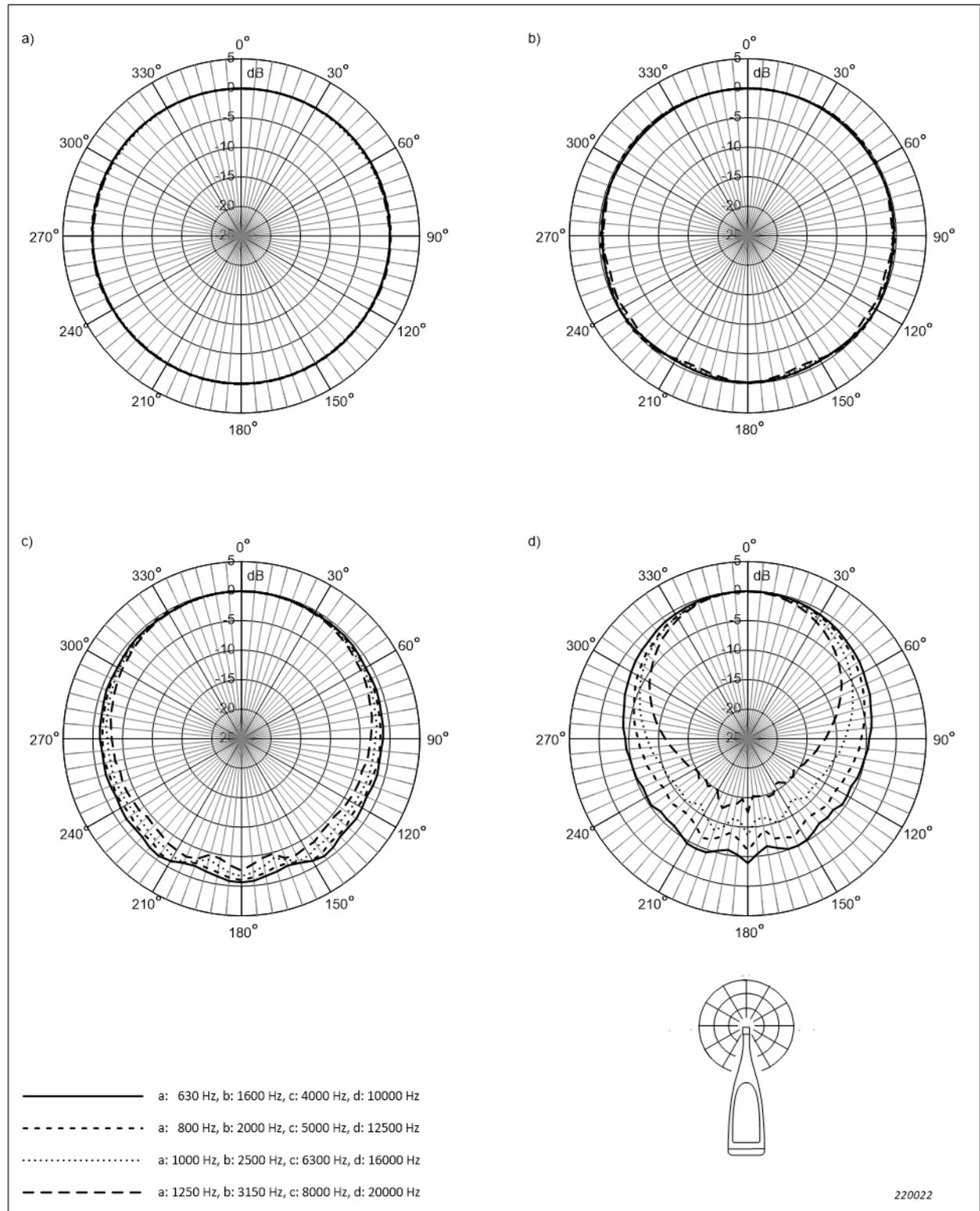
**Fig. 4.13** Risposta direzionale per Microfono Tipo 4966, Preamplificatore microfonico ZC-0043 e fonometro, con preamplificatore microfonico montato direttamente sul fonometro, misurata in un piano perpendicolare al display e lungo l'asse del microfono. Corrisponde dalla Tabella A.16 alla Tabella A.18
