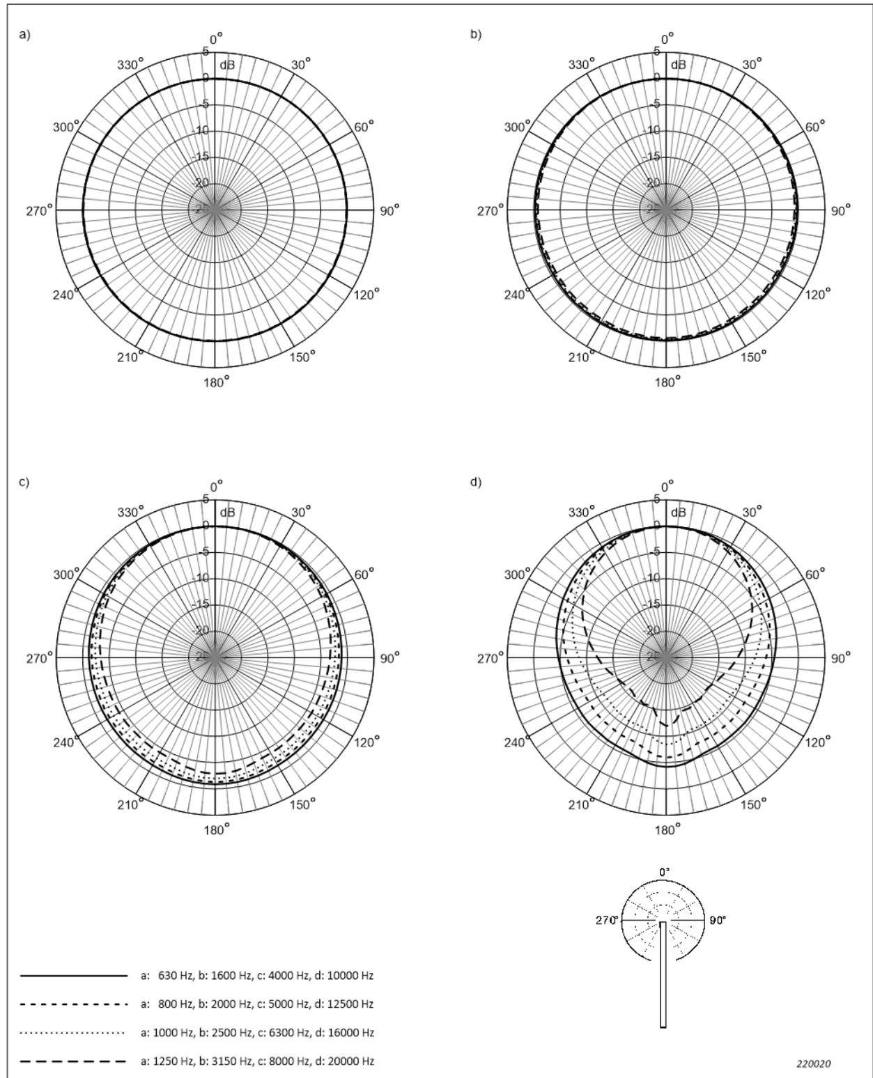
**Fig. 4.11** *Variazioni della sensibilità per Microfono Tipo 4966 e Preamplificatore microfonico ZC-0043 con il preamplificatore microfonico collegato ad una cavo estensione microfono, agli angoli d'incidenza sonora compresi tra  $\pm \theta^\circ$  dalla direzione di riferimento. Corrisponde alla Tabella A.12*
