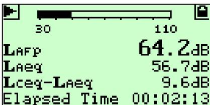
En appont, des statistiques sont disponibles. Un choix de sept valeurs L<sub>N</sub> (de L<sub>1</sub> à L<sub>99</sub>) est affichable. Une courbe de distribution est stockée avec chaque mesure et analysable ultérieurement, par exemple sur un PC où tourne un Logiciel Brüel & Kjær 7820 Evaluator, 7825 Protector ou 7815 Noise Explorer.
