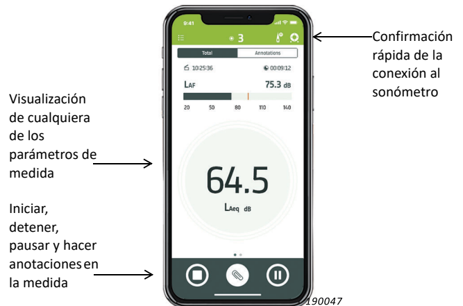
Fig. 3 Control, visualización y anotación de medidas directamente desde su dispositivo móvil
