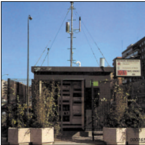
Station permanente de surveillance de bruit à Madrid
